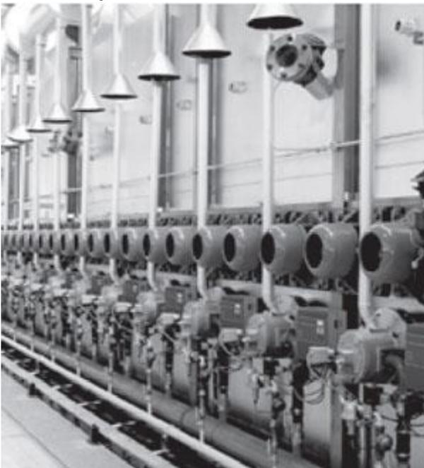
Для контроля пламени горелок Kromschroeder любой мощности с или без надува, на нагревательных печах, топочных установках, промышленных печах и сжигающих установках с продолжительным режимом работы. Горелки Kromschroeder могут разжигаться напрямую или работать в качестве запальной и основной горелок Kromschroeder. UVD 1 может работать только вместе с автоматами управления горелками Kromschroeder типа ВСУ 460-480..U или ПФУ..U.
